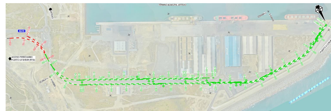
Figura 3. En rojo, Tramo de acceso. En verde, tramo de playa de vías
